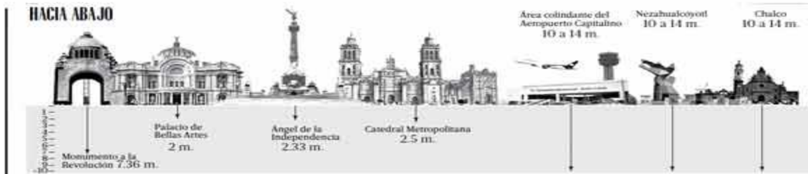
Figura 1. Hundimiento en varios monumentos del centro histórico del D.F.
